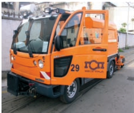
Slike 5 i 6: Izgled višenamenskog vozila "MULTIKAR" za čišćenje šina
