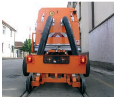
Slike 5 i 6: Izgled višenamenskog vozila "MULTIKAR" za čišćenje šina
